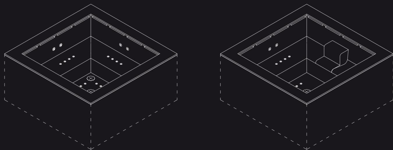
La Minipool realizzata da Wellitaly, con tecnologia EPS, un materiale espanso rigido di peso ridotto e di grande robustezza, permette di effettuare personalizzazioni sui rivestimenti e sulla tecnologia (air, airpool, whirlpool), e con libera scelta sulla forma che più desiderate.
